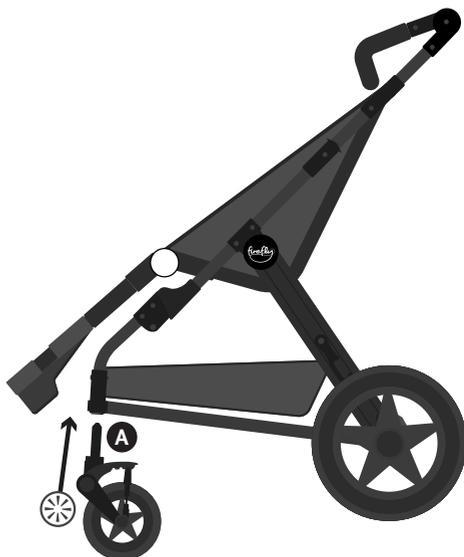
3. Pour bloquer les roues avant en position, les aligner vers l'avant et faire glisser le guide de blocage des roues avant vers le bas. **A**
